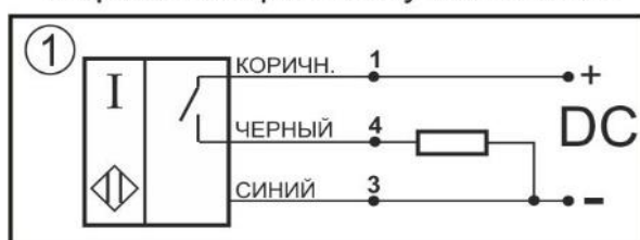
Схема соединения Нормально-разомкнутый контакт
